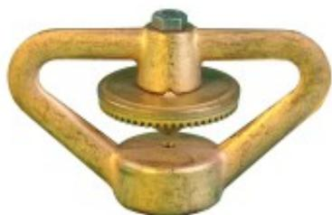
aus Messing, mit 1/2" IG, eignet sich sehr gut für Baumschul- und Strauchbewässerung. Dank ihrer grossen Bohrung von 4 mm, und gleichwohl feinen Verteilung, ist die Düse nicht anfällig auf Verschmutzung. - Wasserdrucklass bei 1 bar : 7.25 l/Min. - Wurfweite: ca. 4.3 m
