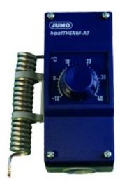
Raumtemperaturregler im Aufbaugehäuse, mit einem Wendelfühler aus CrNi (Edelstahl), Temperatureinstellung von aussen mittels Drehknopf. Ausführung: schlagfestes Kunststoffgehäuse, Schutzart IP 54.
