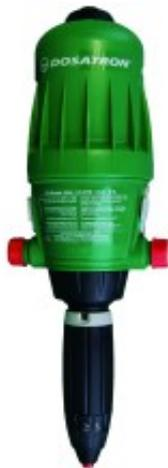
gewährleistet eine genaue Dosierung, bei Veränderung der Förderleistung und des Druckes, passt sich die Einspritzvorrichtung an. Betriebsförderleistung von 10 - 3'000 l/Std., 0.3 - 6 bar, Dosierskala 0.2 - 2 %, 3/4" Anschluss. Weitere Vorteile: - kein Stromnetz nötig - breite Dosierskala - Aussenregulierung - getrenntes Einspritzsystem - integriertes Rührwerk - eingebautes Umlaufsystem - kompakt und tragbar
