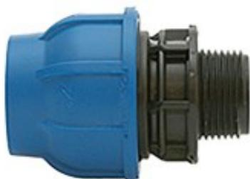
Connecto™ + PE-Verschraubungen PN16 / PN10, zertifiziert für Trinkwasser, 16 bar, Typ 411 auf Anfrage lieferbar von ø 16 mm x 1/2" AG bis ø 110 mm x 4" AG
