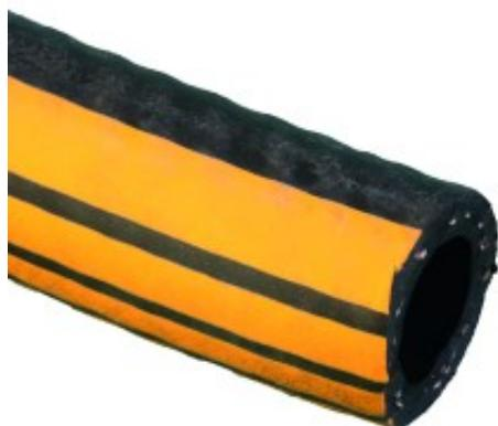
aus EPDM, schwarz mit 4 orangen Längsstreifen, innen Ø 25.4 mm, Wandstärke 4.8 mm, Temperaturbereich -30 °C bis +100 °C, 20 bar
