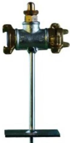
mit Spritzkonus, stufenlos regulierbar, für Reinwasser, fest montiert auf Bodeneinsteckstativ Länge: 50 cm, mit Geka®-Anschluss und Geka®-Blindkupplung - Betriebsdruck: 2 bar - Wasserverbrauch: 20 l/Min. - Berechnungsfläche:  $\varnothing$  9 m - Düsendistanz: 5 m
