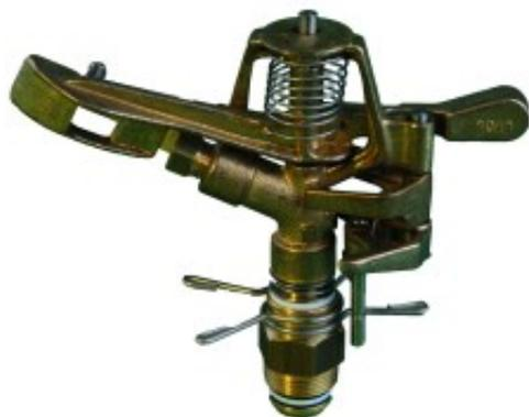
Regnerkopf, Schwinghebel sowie die zwei Umschalthebel sind aus Super-Bronze gegossen - Federn, Achse und Stifte sind aus nicht-rostendem Stahl - Anschlussmutter, Spindel und Düse aus Messing - sand- und schmutzabstossendes Speziallager - absolut wartungsfrei inkl. Strahlstörerdüse zur Regulierung der Wurfweite
