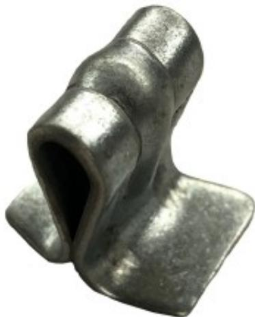
Die seitlichen Klammerfüsse sind schräg nach oben gerichtet, so dass der Scheibendruck die Elastiks nach innen zum Steg presst. Dadurch erfolgt eine gegenseitige feste Verriegelung. Diese Sturmklammern sind auch ohne Elastikblocks verwendbar. Klammerbreite 20 mm für Stahlsprossen T-25, T-30 und T-35. Klammer allein
