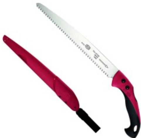
mit auswechselbarem Stahlblatt patentierte grobe Zahnung auf Zug mit konischem Querschnitt und mit Hakengriff aus Kunststoff und Kunststoffschutzkappe für das Sägeblatt. Blattlänge : 33 cm | bis ø 100 mm | Gewicht 370 g
