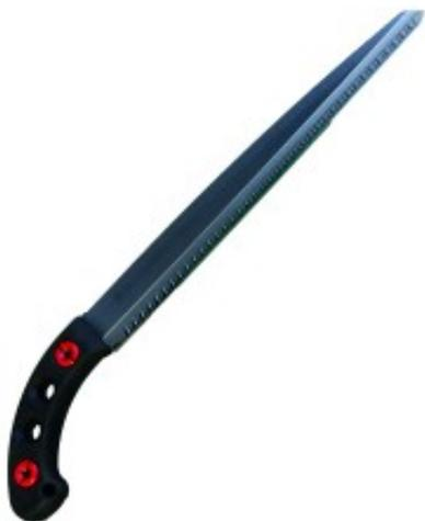
die Silky-Sägen zeichnen sich durch ihre spezielle Zahnform - welche konkav geschliffen ist - aus. Dadurch entsteht eine sehr glatte Schnittfläche welche eine schnelle Wundheilung der Pflanzen ermöglicht. - Zähne impulsiv gehärtet - Verzahnung : grob (8 Zähne je 30 mm) - für frisches Holz geeignet - Hart-Chrom beschichtet Säge mit feststehendem Sägeblatt
