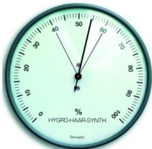
hygromètre analogue avec des aiguilles synthétiques, boîtier avec arceaux en métal, gris. Grandeur : ø 100 mm | Poids : 105 g
