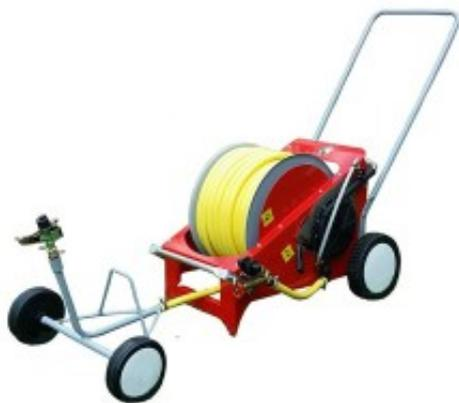
40 m - 3/4" tuyau PVC, entraînement par turbine 10 - 20 m/h, intensité d'irrigation réglable, distance de projection jusqu'à 10 m (à 4 bar), débit environ 0.6 - 0.9 m<sup>3</sup>/h, chariot d'arrosage avec arroseur à secteur, arrêt automatique, 35 kg
