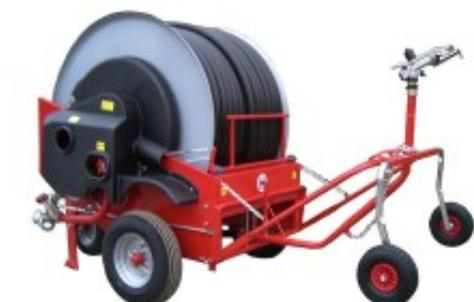
150 m de tuyau PE 1 1/2", entraînement par turbine 10 - 30 m/h, intensité d'irrigation réglable, distance de projection jusqu'à 25 m (à 5.5 bar), débit d'environ 5.2 - 12 m<sup>3</sup>/h, chariot d'arrosage avec arroseur à secteur, soupape de surpression, arrêt automatique, guidage automatique du tuyau pour l'enroulement, 393 kg
