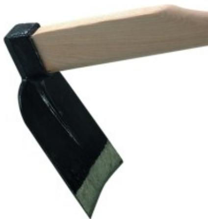
forgé d'une seule pièce, demi-poli, avec manche en frêne 140 cm de long - longueur de la lame : 20 cm - largeur de la lame : 14 cm - poids : 1.85 kg
