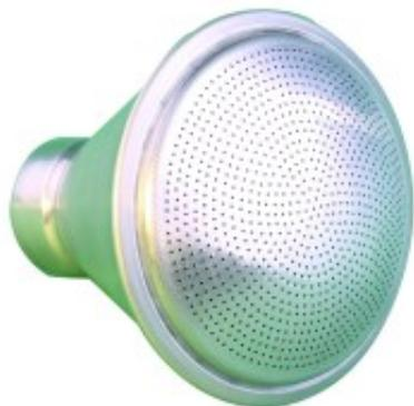
pour visser sur tuyau avec M 3/4", légère, moulé pour un jet d'eau large et doux, trous de tamis  $\varnothing$  0.7 mm
