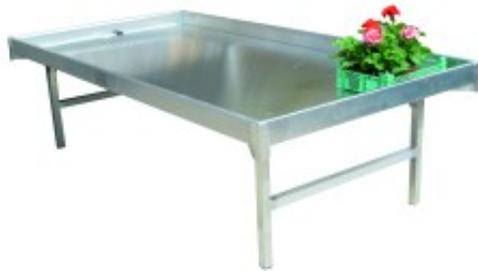
Construction de table stable appropriée pour l'exposition de plante avec arrosage, max. 300 kg/table. Version sans accessoires : - design léger en alu intégral - bac en une seule pièce de tôle d'aluminium de 1.5 mm - coins soudés étanches - sans construction de cadre supplémentaire - 4 pieds enfichables avec bande plastique - empilable - 2 gros bouchons de vidange - profondeur du bac 90 mm - sur demande avec roulettes - pieds réglables +/- 25 mm (plus disponible avec les roulettes)
