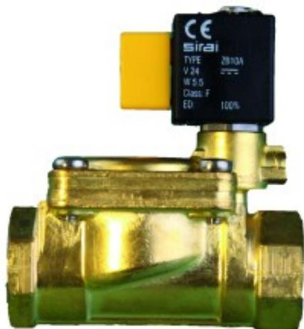
en laiton, avec ouverture manuelle, les deux côtés avec filetage intérieur, coups faibles à l'ouverture ou à la fermeture. En position fermé en cas de coupure de courant. 24 V AC
