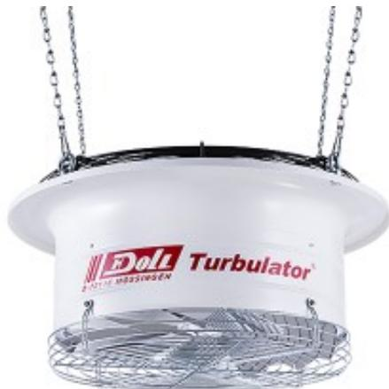
pour serres, boîtier en acier inoxydable avec 4 oeillets de suspension sur le ventilateur, économies d'énergie élevées en hiver grâce à la récupération de chaleur dans la serre ou dans la zone de mesure des sondes. Données techniques : - tension : 230 V - fréquence : 50 Hz - brassage : jusqu'à 5'000 m<sup>3</sup>/h - nombre de tour : 940 t/min. - puissance absorbée : max. 165 W - consommation de courant : 0.8 A - température : -25° C à +40° C - réglage progressif
