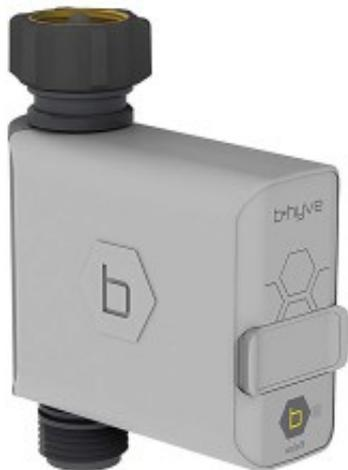
connection à travers Bluetooth®, paramétrage via application gratuite pour Android ou iOS - entrée fileté F 3/4" - sortie fileté M 3/4" - pression d'eau en fonctionnement : 0.68 jusqu'à 6.81 bar - température de fonctionnement : 0° C jusqu'à +70° C - uniquement pour une utilisation extérieure avec de l'eau froide - nécessite 2 piles alcaline de 1.5 V (non comprises)
